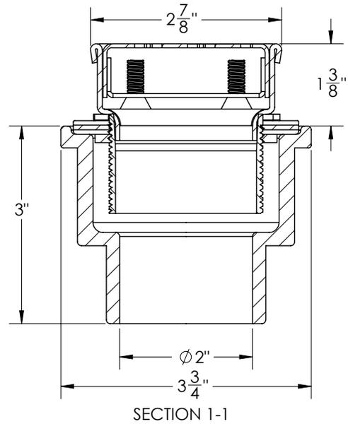
2 INCH CLAP DOWN DRAIN ASSEMBLY
